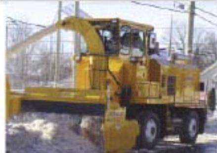
Souffleuse automotrice LARUE T60 R36 à propulsion hydrostatique, moteur Cat C9 350 hp, vis à ruban de 36 po, turbine de 40 po et chute télescopique
