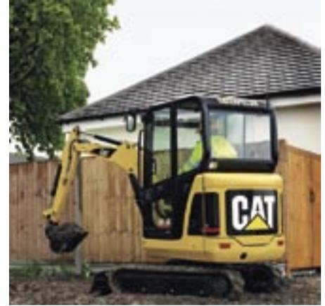
flèche à pivotement indépendant permet à la machine de travailler à côté d'un mur ou d'un obstacle. La rotation du godet sur 200° garantit une bonne rétention du matériau à la hauteur et offre la possibilité de creuser des tranchées à fond plat. Un choix de longueurs de bras et d'outils de travail Cat et la fonction libre de la lame rendent les 301.6C et 301.8C encore plus polyvalentes.
