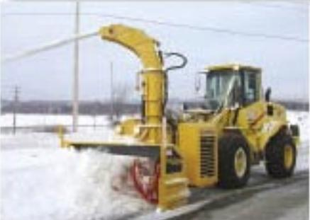
Souffleuse détachable LARUE D55 mécanique, 300 hp, 8500 lb, vis à ruban de 36 po, turbine de 40 po et chute télescopique
