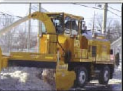
Souffleuse automotrice LARUE T60 R36 à propulsion hydrostatique, moteur Cat C9 350 hp, vis à ruban de 36 po, turbine de 40 po et chute télescopique
