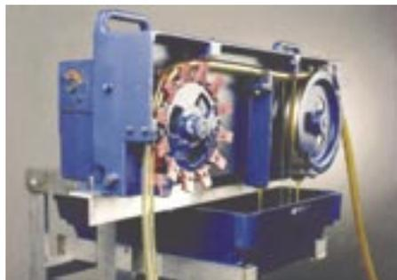
L'huile adhère à la surface extérieure d'un tube collecteur en boucle qui est lentement tiré à la surface de l'eau. Il passe ensuite dans l'écumeur où des racleurs retirent l'huile qui peut être ainsi récupérée.
