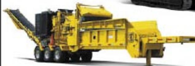
Le HG6000 est monté sur un châssis semi-remorque
