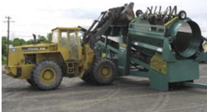
Après le lancement en 2007 du Roto-Screen LD avec alimentateur surbaissé, spécialement conçu pour les chargeurs de petite taille, la compagnie lancera au printemps 2008 un tamiseur de plus grande taille qui viendra combler les besoins d'une partie de la clientèle qui recherche une plus grande productivité.
