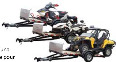
Grâce à ses dimensions de 173 cm (68") de largeur entre les ailes et 305 cm (120") de longueur, cette nouvelle remorque vous permettra de transporter ces véhicules avec aisance.
