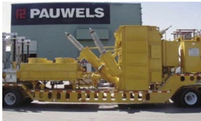
Un transformateur électrique coûtant plusieurs millions de dollars qui sera installé dans un environnement très corrosif, aura besoin du meilleur revêtement disponible : un polyuréthane ou un uréthane acrylique.
