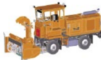
Souffleuse automotrice LARUE T60 R36 à propulsion hydrostatique, moteur Cat C9 350 hp, vis à ruban de 36 po., turbine de 40 po. et chute téléscopique
