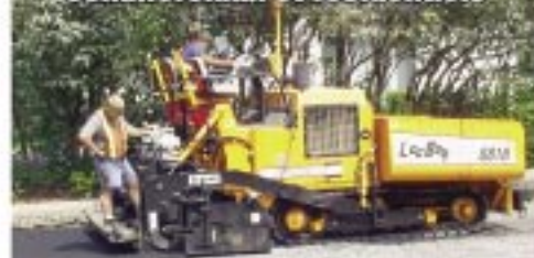
LeeBoy 8816 Moteur Cummins de 130 hp, table Legend™ 8 à 16 pi avec 10% de pente sur les extensions, vis d'alimentation de 14 po à vitesse variable et portes découpées
