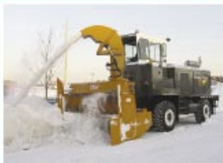
Souffleuse à neige LARUE 7060 série 226 à propulsion hydrostatique, moteur Detroit diesel série 60 533 HP
