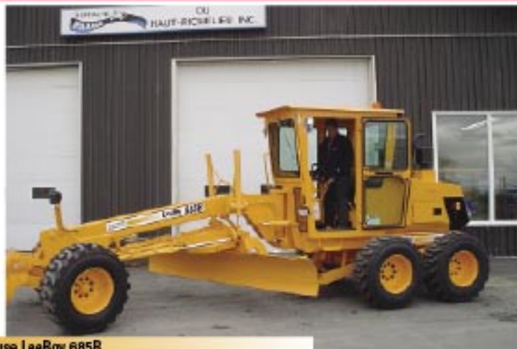
Niveleuse LeeBoy 685B Châssis articulé sur 30 degrés, transmission hydrostatique, moteur Cummins turbo 110 hp, lame avant et scarificateur
