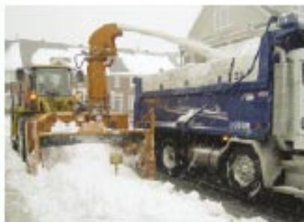
Souffleuse détachable LARUE D55 mécanique, 275 hp, 8500 lb, vis à ruban de 36 po., turbine de 40 po. et chute téléscopique
