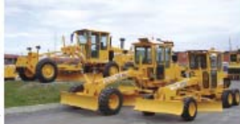
Niveleuse LeeBoy 785 Châssis articulé sur 40 degrés, transmission «PowerShift» à 6 rapports, moteur Cummins turbo 130 hp, lame avant et scarificateur.
