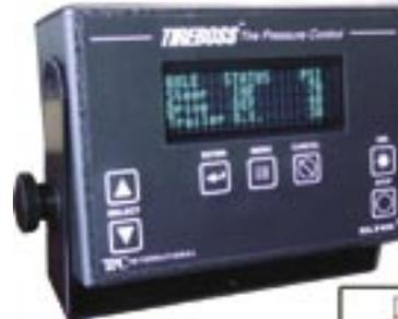
pneus (CTI), diffère des autres systèmes sur le marché. Non seulement elle permet une réduction de pression des pneus en fonction de la charge et de la vitesse du véhicule, mais elle permet également au conducteur de les regonfler!
