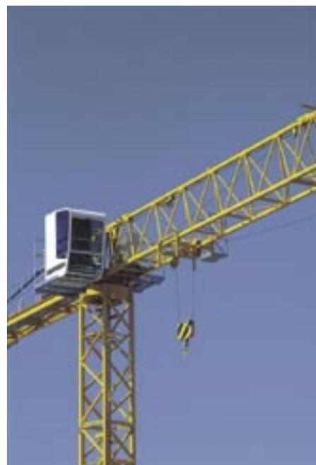
standard. Ainsi, la partie supérieure complète de la grue 71 EC-B 5 (contrepois inclus ainsi que les deux éléments de mât de chacun 11,7 m) est transportée sur seulement deux camions.
