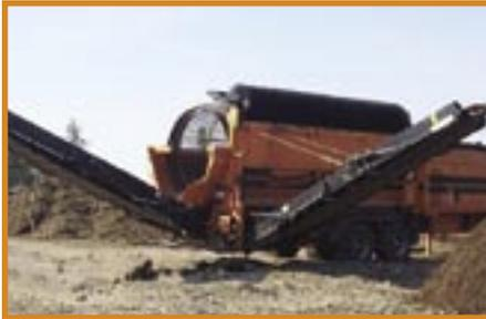
Tamiseur DOPPSTADT SM618 2004, équipé de 2 convoyeurs de 5 m, graissage automatique, pattes hydrauliques, grillage à roches automatisé, 2 cribles (20mm & 40mm). Peu d'heures
