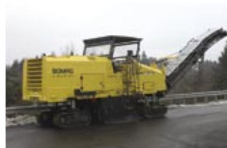
La gamme est constituée du BM 300/100, prévu pour les chantiers urbains avec une puissance d'environ 300 hp et une largeur de travail de 1000 mm et du BM 300/130 avec une largeur de découpe de 1300 mm. Ces deux modèles disposent de quatre trains de chenille directeurs et d'un convoyeur rabattable vers l'avant.
