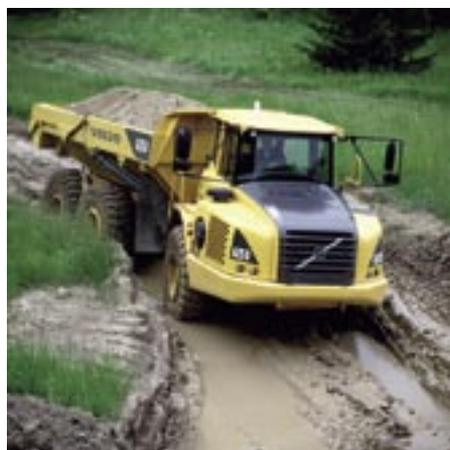
du moteur Volvo D9, qui optimise encore la consommation de carburant. Le D9 est basé sur les mêmes technologies que le Volvo D12 monté sur les tombereaux A35D et A40D. Ces deux moteurs diesel consomment peu de carburant et sont peu polluants.
