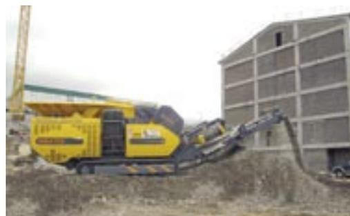
béton armé ont été concassés en 0/45 mm et ont pu être réutilisés comme prévu pour la production du béton. Le séparateur magnétique généreusement dimensionné a assuré de façon fiable l'extraction des pièces métalliques. C'est ainsi que le projet entier a pu être achevé dans les délais – à la satisfaction générale des personnes impliquées. L'intervention du RM70 avait suscité un grand intérêt – et une demande croissante à la grande joie de l'exploitant.
