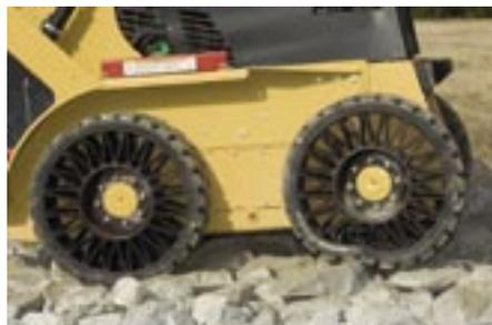
Le Michelin TWEEL remplace à lui-seul l'assemblage pneu-roue traditionnel.
