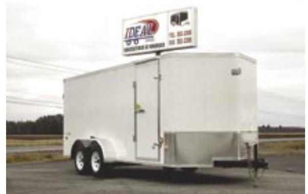
est peinte au complet avec une peinture époxy et possède une isolation thermique entre la structure métallique et l'aluminium extérieur pour empêcher la corrosion de l'aluminium. Les remorques sont vissées uniformément de façon à ce que la surface soit lisse et entre chaque vis. Le toit est très étanche car nous utilisons des rubans butyls
