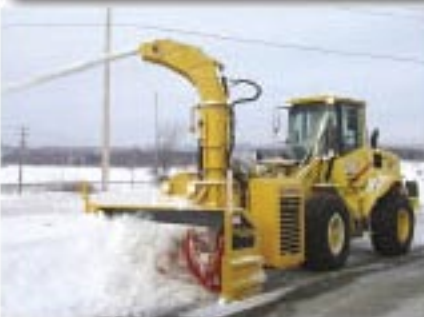
Souffleuse détachable LARUE D55 mécanique, 300 hp, 8500 lb, vis à ruban de 36 po, turbine de 40 po et chute télescopique
