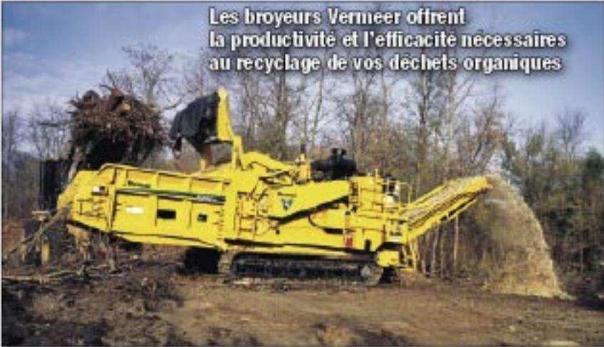
Le HG6000TX est monté sur chenilles permettant de se déplacer de façon autonome sur le chantier.
