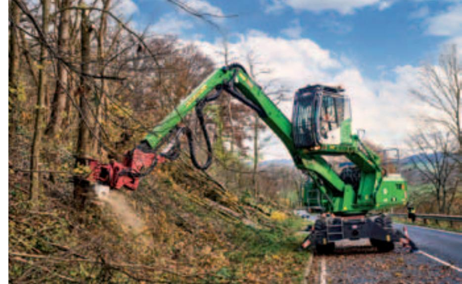
NEBOGEN 718 E avec une tronçonneuse à grappin pour l'abattage des arbres le long des routes. Les opérations effectuées avec des machines comme la 718 E nécessitent moins de main-d'œuvre. En outre, l'opérateur est protégé par des dispositifs de sécurité tels qu'une protection complète et des fenêtres de cabine en verre blindé.
