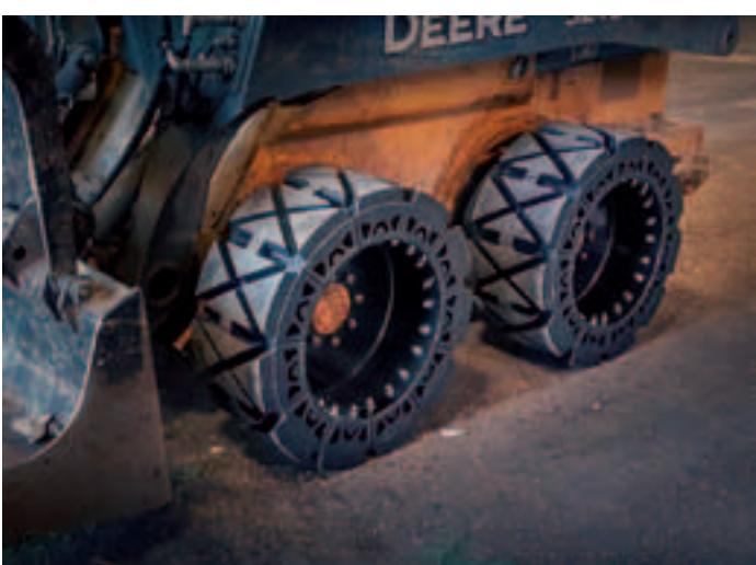
qui comporte des ouvertures à l'intérieur du caoutchouc. La géométrie spécialisée de la carcasse de ces pneus leur permet de se comprimer sans rebondir. La conception de la bande de roulement permet également à la machine de glisser en douceur afin que l'opérateur puisse solliciter davantage et d'augmenter sa productivité.
