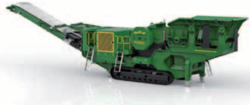
changeants des projets et des opérations d'aujourd'hui. La mobilité continue d'être une caractéristique avec des chenilles commandées à distance pour déplacer et positionner facilement le concasseur.
