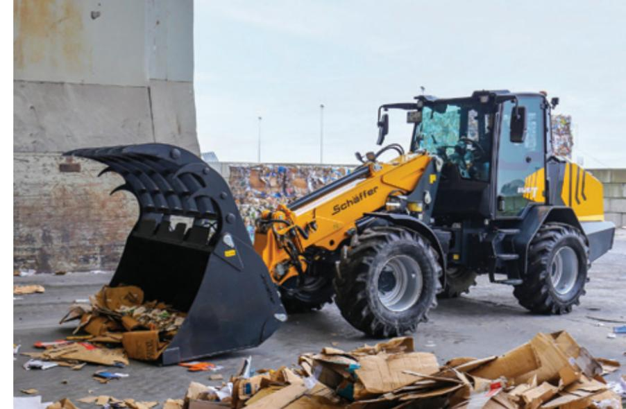
de 5,40 m. Le 9640 T-3 est équipé de série d'un système hydraulique à détection de charge d'un débit de 172 l/min, également disponible en option pour le 8620 T-3.
