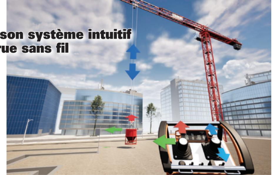
éliminé. Au lieu de cela, WOLFF Intuitive Control utilise un système de mouvement cartésien, permettant un contrôle intuitif de la charge : Déplacez l'élément de commande vers l'avant, et la charge se déplace vers l'avant. Il en va de même pour
