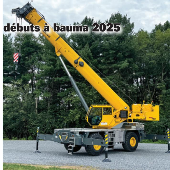
contrepoids de 1360 kg pour des performances encore accrues. Pour un montage automatisé rapide et facile, chacune de ces configurations est compatible avec le système optionnel de montage hydraulique du contrepoids. Malgré sa cabine plus spacieuse, la largeur hors tout de la GRT780 reste inférieure de près de 300 mm à celle des grues concurrentes.
