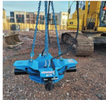
variante choisie, il pèse 450 kg, 550 kg ou 600 kg. Cela signifie qu'il est suffisamment petit pour être très maniable, mais qu'il a la capacité nécessaire pour s'attaquer aux pieux préfabriqués les plus difficiles.
