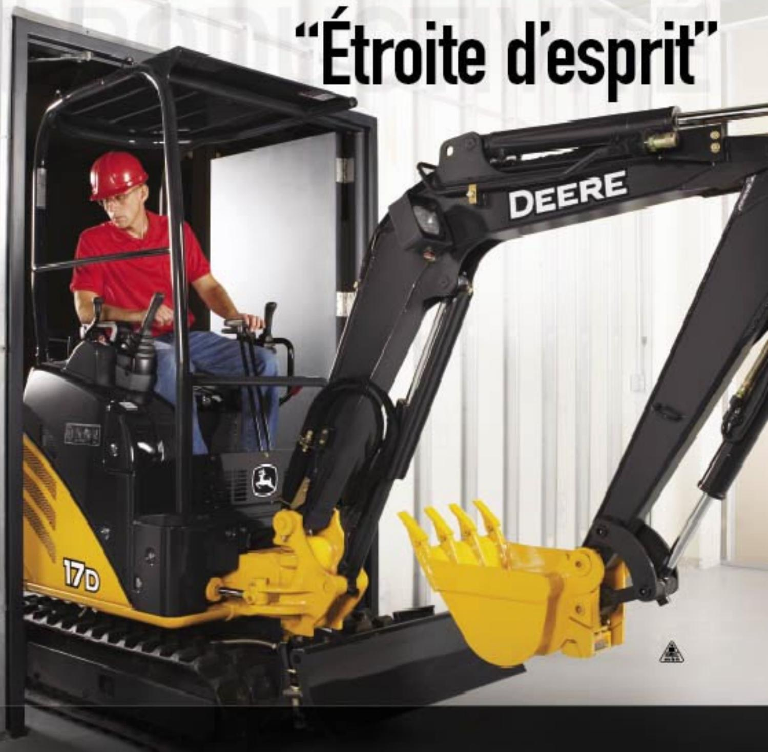
La nouvelle 17D compacte n'en mène pas large quand il faut manoeuvrer à l'étroit. Le rétrécissement hydraulique des chenilles et le repliage de la lame lui permettent de traverser un portique d'à peine 99 cm de largeur. Il suffit alors de ramener les chenilles à 127 cm pour fournir une bonne stabilité. Composez le 1-800-503-3373 ou consultez votre concessionnaire pour voir comment l'étroitesse de l'excavatrice 17D peut élargir vos horizons.
