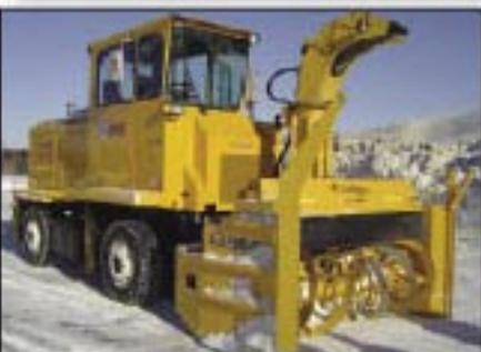
Souffleuse automotrice LARUE T60 R36 hydrostatique, moteur Cat 375 hp, vis à ruban ou à double vis. Disponible avec AWS et chute télescopique
