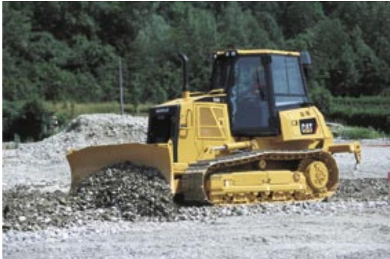
GPS pour commander la lame de manière automatique et précise afin d'obtenir une précision optimale du niveau définitif.
