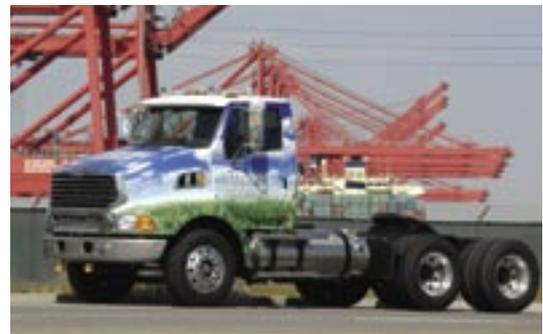
municipaux. Ce camion assemblé entièrement à l'usine est propulsé par un moteur Cummins Westport ISL G.
