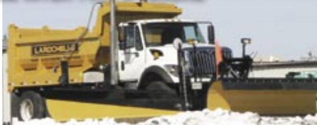
Équipement à neige LAROCHELLE neufs : benne-épineur en «U» 14 pieds (décharge avant gauche), gratte réversible avec attache rapide, aile de côté avec positionneur d'aile, système pré-trempage 1200 litres, contrôle d'épandage électronique et contrôles à air .....Prix sur demande
