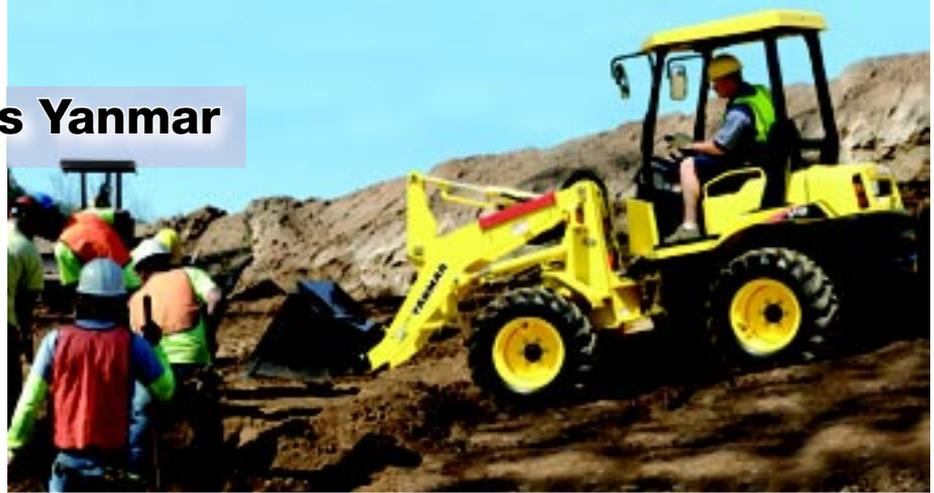
changements de rapport sans intervention de l'opérateur. Un mode à vitesse fixe permet de maintenir le chargeur en première vitesse peu importe la position de la pédale d'accélérateur. Le mouvement en marche avant et arrière est contrôlé à l'aide d'un levier monté sous le volant.
