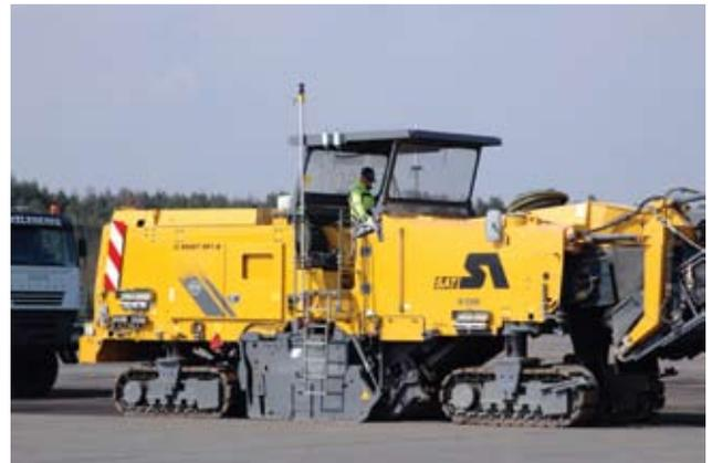
satisfait du déroulement du chantier et du résultat. Les deux W 2200 ont accompli un travail exceptionnel et, grâce au système de contrôle en 3D, réalisé un nouveau profil selon les prescriptions exactes du modèle numérique du terrain. Cette technologie n'est en principe pas plus compliquée que d'autres méthodes de nivellement, mais il est important de bénéficier d'une expertise et d'une expérience en matière de mesurage pour être capable de résoudre les missions les plus ambitieuses.»
