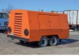
Compresseur à air SULLIVAN modèle D9000, moteur diesel Cat 3306.
