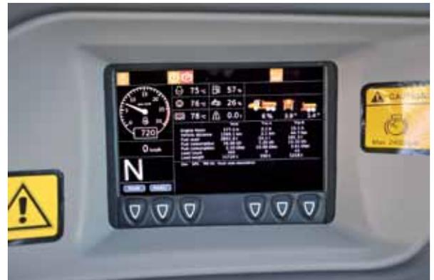
s'affichent au tableau de bord sous forme de graphiques clairs et didactiques qui signalent à l'opérateur s'il peut continuer à avancer en toute sécurité ou s'il doit arrêter la machine en raison d'un risque de basculement.
