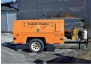
Compresseur à air SULLIVAN modèle D250 O, moteur diesel John Deere
