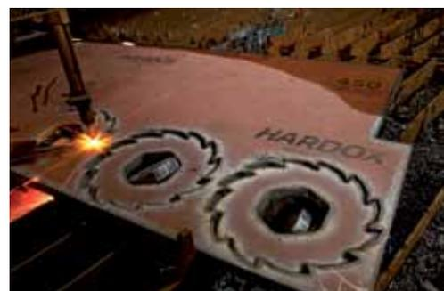
nécessitent des surfaces très dures. Il offre une résistance à l'usure et à la chaleur hors du commun (jusqu'à 590°C), faisant de lui un matériau idéal pour les cimenteries.
