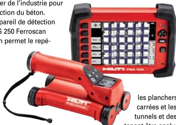
rage rapide de barres d'armature, leur emplacement et leur diamètre, ainsi que d'autres objets ferreux dans les structures en béton. Avec le PS 250, l'utilisateur peut facilement et rapidement inspecter une
