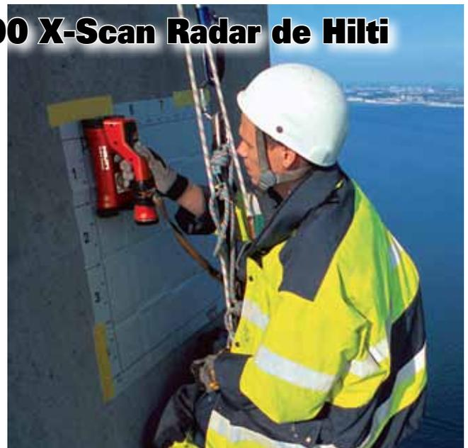
dimensions de ce qui se trouve à l'intérieur des structures en béton. Son nouveau capteur EM permet la détection de câbles sous tension (50/60 Hz) enfouis jusqu'à 76 mm dans le béton.
