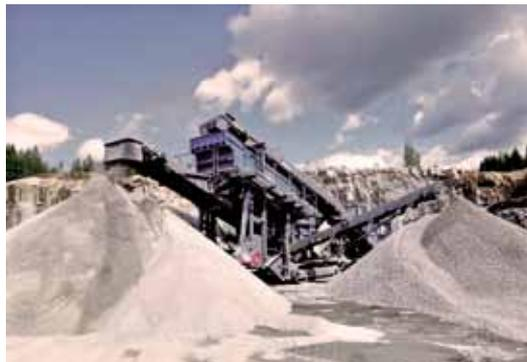
seur pour la deuxième ou la troisième étape de concassage et permet, avec son crible intégré à trois étages et le circuit fermé du matériau, la production de trois tailles de grains définies.
