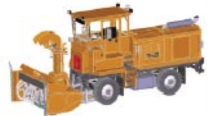
Souffleuse automotrice LARUE T60 R36 à propulsion hydrostatique, moteur Cat C9 350 hp, vis à ruban de 36 po., turbine de 40 po. et chute télescopique
