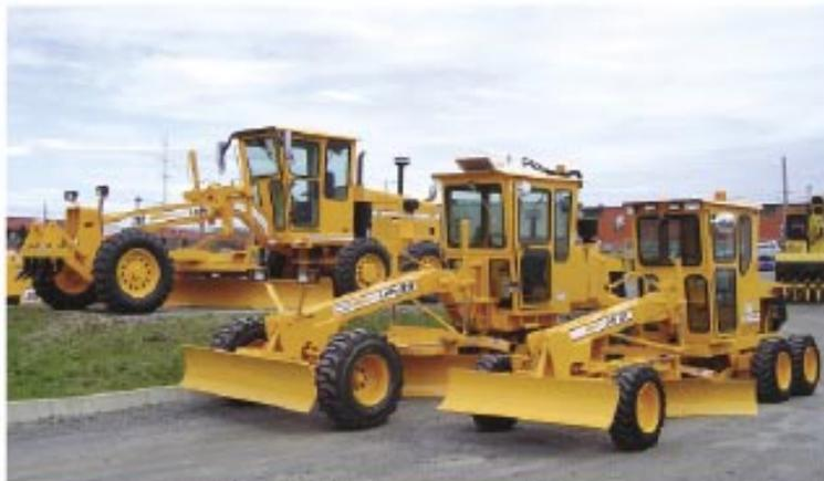
Niveleuse LeeBoy 785 Châssis articulé sur 40 degrés, transmission «powershift» à 6 rapports, moteur Cummins turbo 130 hp, lame avant et scarificateur. Trois modèles disponibles, de 50 à 130 hp
