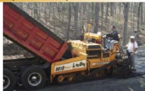
LeeBoy 8816 Moteur Cummins de 130 hp, table Legend™ 8 à 16 pi avec 10% de pente sur les extensions, vts d'alimentation de 14 po à vitesse variable et portes découpées
