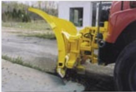
maximale. Lorsque qu'un élément passe un obstacle, la suspension permet à ce panneau d'absorber le choc sans nuire à l'efficacité du déneigement des autres éléments.
