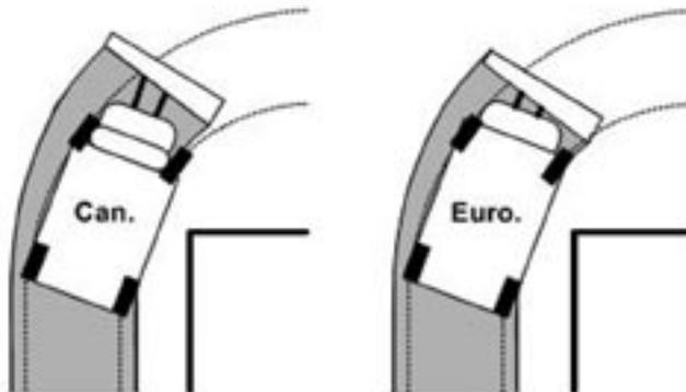
lignes des roues, à un point que les roues peuvent tout simplement sortir de l'aire grattée, sauf à allonger démesurément la largeur de la gratte ;
