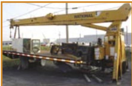
Grue NATIONAL modèle 666, 14 tonnes, 66 pieds de flèche, c/a cabine et plate-forme.
