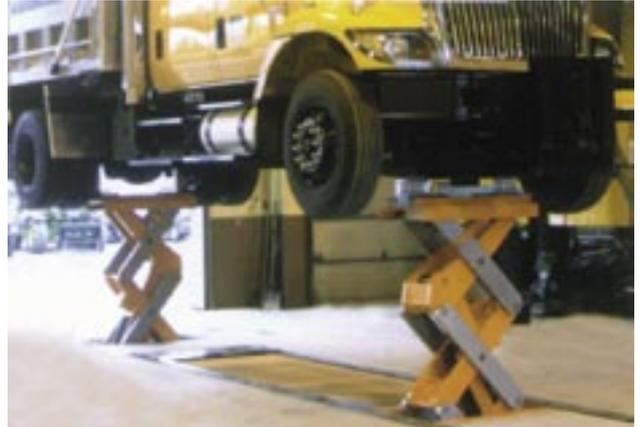
L'ECO60 est monté avec 4140 goupilles en acier durci et douilles Polygon® sans lubrifiant pour une utilisation sans souci et un entretien minimal.
