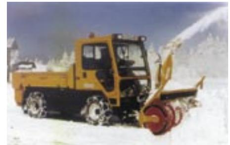
Complètement hydrostatique et doté d'une direction au 4 roues, il peut rouler de 0-20 km/h en mode travail et de 0-50 km/h en mode déplacement.
