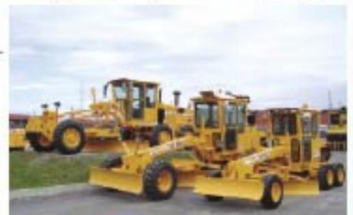
Niveleuse LeeBoy 785 Châssis articulé sur 40 degrés, transmission «PowerShift» à 6 rapports, moteur Cummins turbo 130 hp, lame avant et scarificateur.
