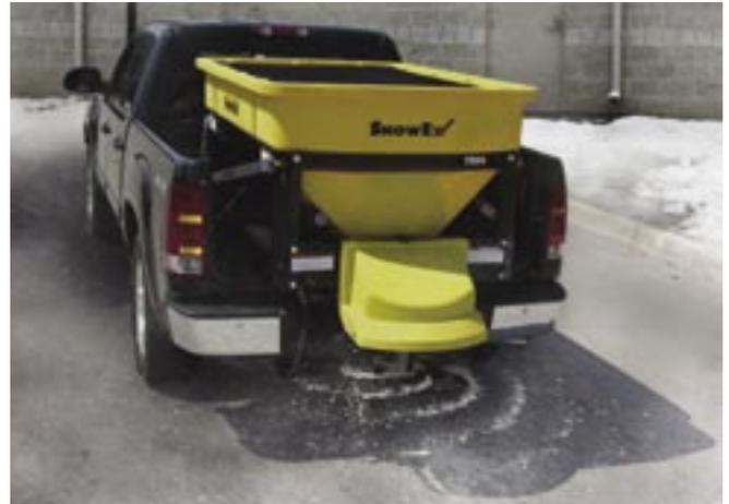
Destiné aux camionnettes pickup standard, avec plateau de 1,80 m et plus, le SnowEx 7500 comporte la même trémie multiangle brevetée et la chicane en V inversé que l'on retrouve sur les autres épandeurs SnowEx. Combinée à un vibreur, la trémie permet un débit continu du mélange sel/sable, de 100% sel jusqu'à une proportion 50/50 de sel et de gravillons. La nouvelle dalle longitudinale réduit également le risque de blocage du mélange.
