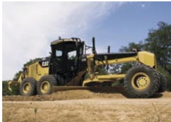
ifiques à gauche et à droite, qui permettent un contrôle indépendant du débit hydraulique à chaque moteur hydrostatique de roue avant. Pour compenser la demande en puissance hydraulique, le moteur augmente automa-
