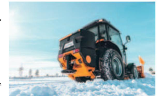
Le réglage électrique en continu de la largeur d'épandage permet de choisir la largeur d'épandage et permet même un épandage asymétrique. Kugelmann fabrique aussi des équipements pour le balayage et la tonte de gazon.
