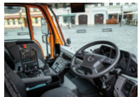
en option de la direction bimode VarioPilot® qui permet de déplacer le volant et les pédales de gauche à droite de la cabine. Le conducteur peut ainsi adopter une position adaptée à la tâche spécifique qu'il doit accomplir. Par exemple, lors du balayage, il bénéficie d'une vue dégagée sur les machines de travail.
