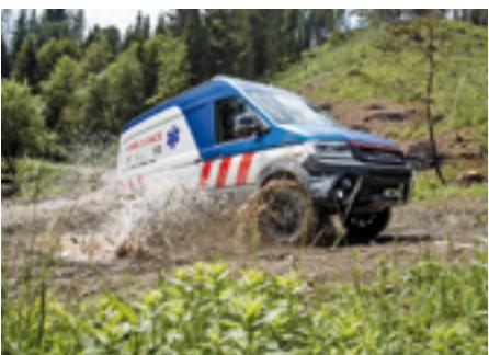
Basé sur un châssis Volkswagen Crafter/MAN TGE 4Motion, le 4x4 TORSUS TERRASTORM est équipé d'un moteur diesel 2.0 l biturbo proposé en 2 puissances nominales, 140 hp et 250 lb pi 177 hp et 300 lb pi, couplé à une boîte manuelle à 6 vitesses ou à une boîte automatique à 8 vitesses.
