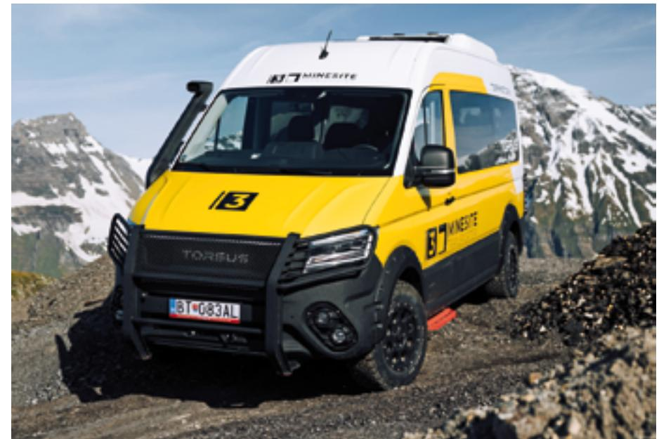
série de configurations qui comprennent toutes un différentiel arrière verrouillable, un treuil de 5,5 t intégré dans le pare-chocs avant et des plaques de protection.
