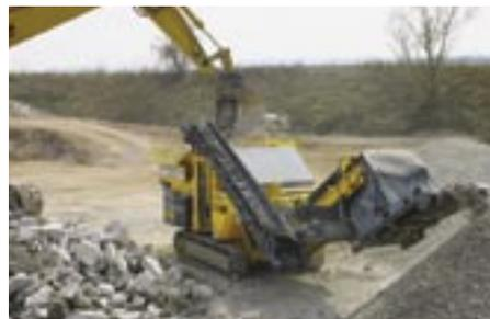
À la fois primaire et secondaire, le RM-80 peut produire du matériel conforme 0-3/4 po en une seule opération. Facilement transportable grâce à son poids de 23 t, le concasseur Rubblemaster se mobilise en moins de 10 min. La conception et la productivité du RM-80 réduit au maximum les coûts
