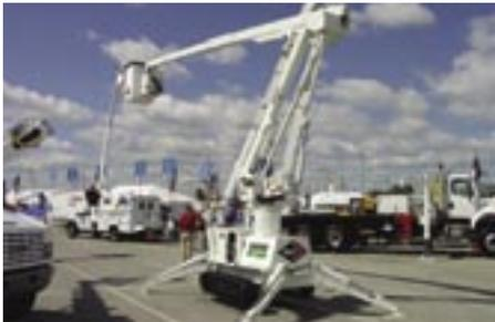
Le système breveté «Electrogard» procure jusqu'à 42 po de dégagement peu importe la position du bras télescopique. Un coup d'oeil permet de vérifier si chaque boulon est solidement attaché et si l'unité est sécuritaire pour des opérations.
