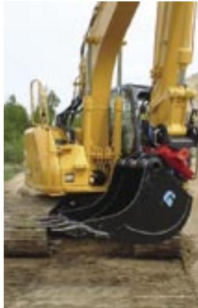
La flexibilité du Rototilt permet à l'excavatrice de travailler dans des endroits restreints et d'exécuter des fonctions qui exigeraient normalement de l'équipement spécialisé, des machines, ou de la main-d'oeuvre supplémentaire.
