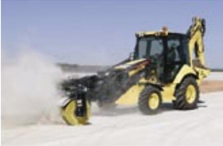
Parmi les caractéristiques de la Série E, on note les pinces montées d'usine offertes pour les godets de pelle rétro – une option exclusive à Cat et l'attache de godet à accouplement à un axe qui permet d'effectuer des rotations à 205°, peu importe l'application, ce qui en fait la meilleure de sa catégorie. Ainsi, vous pouvez passer d'un outil à un autre sans changer d'attache.
