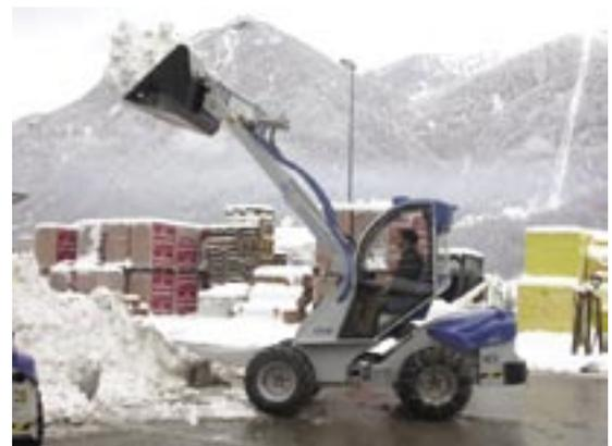
un problème. Le système breveté «Swing Lock» augmente l'adhérence sur les terrains accidentés. Le bras télescopique du MultiOne GT peut atteindre plus de 4 m de hauteur et permet de charger du matériel même au-delà du centre du châssis.
