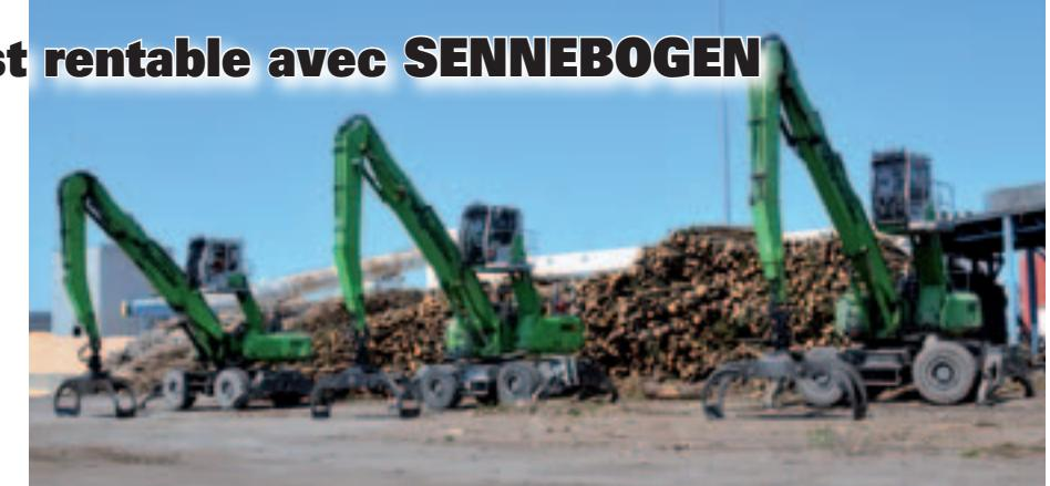
maintenance mécanique de l'usine. «Elle est mécaniquement solide et nous fournit une excellente exécutabilité pour notre exploitation. La première est maintenant à 58 000 heures. Nos techniciens lui ont installé un nouveau moteur il y a 2 ans, à 42 000 heures. L'ancien moteur fonctionnait encore bien, mais nous souhaitons être proactifs et éviter tout risque qu'il puisse connaître une défaillance. Nous ne voulions pas nous retrouver à une machine.»
