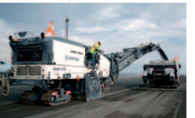
tambours de fraisage et groupes de fraisage avec des largeurs de travail de 1,5 m, 2,0 m et 2,2 m pour obtenir des niveaux de flexibilité et de performance supérieurs. Trois vitesses de rotation du tambour de fraisage permettent d'obtenir des ren-
