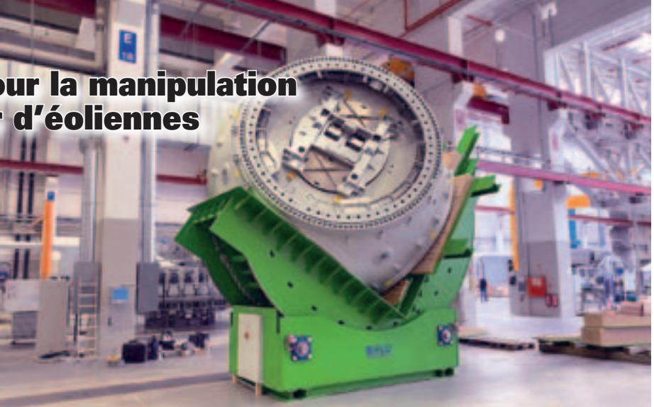
lation d'outils et d'autres charges qui se mesurent en tonnes. Malgré sa capacité de charge élevée, les dimensions compactes du retourneur de moyeux de rotor de RUD sont également impressionnantes.
