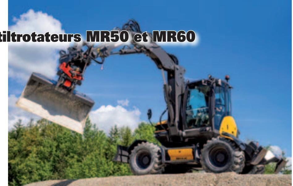
Mecalac en font les meilleurs porteurs d'outils possibles pour un tiltrotateur. La cinématique brevetée Mecalac est tout à fait indiquée. Le bras qui se positionne très en arrière est parfait lorsque l'on rajoute du poids en bout de balancier, car il fait alors office de contrepoids. Quant à la volée variable elle vous permettra de positionner l'outil de la manière la plus adaptée lors de l'utilisation de votre tiltrotateur.
