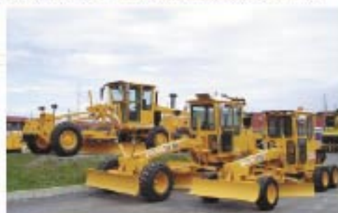
Niveleuse LeeBoy 785 Châssis articulé sur 40 degrés, transmission «PowerShift» à 6 rapports, moteur Cummins turbo 130 hp, lame avant et scarificateur.
