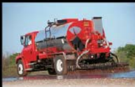
Épandeur à colasse Rosco Maximizer III
