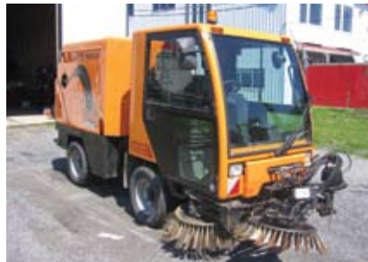
Balai aspirateur de rue BUCHER CITYCAT 2000 1997, mot. diesel Kubota, trans. hydrostatique, réservoir d'eau, 3 brosses avant hydrauliques, balai et aspiration.
