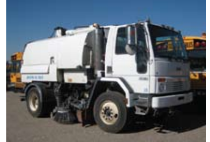
Balai aspirateur JOHNSTON 605 1999, avec vide puisard, sur chassis STERLING SC7000.
