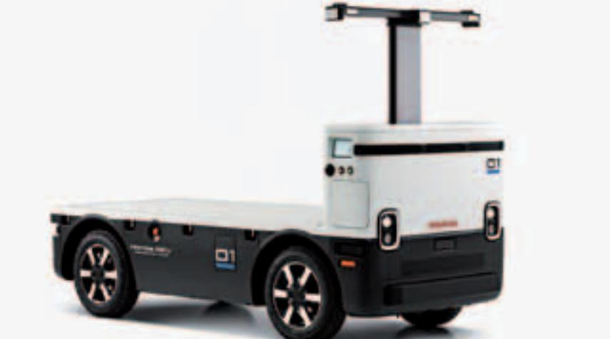
le prototype de 3<sup>e</sup> génération présente des améliorations, notamment un plateau permettant de transporter 2 palettes, une capacité de chargement de 907 kg et une hauteur de chargement abaissée améliorant l'ergonomie.
