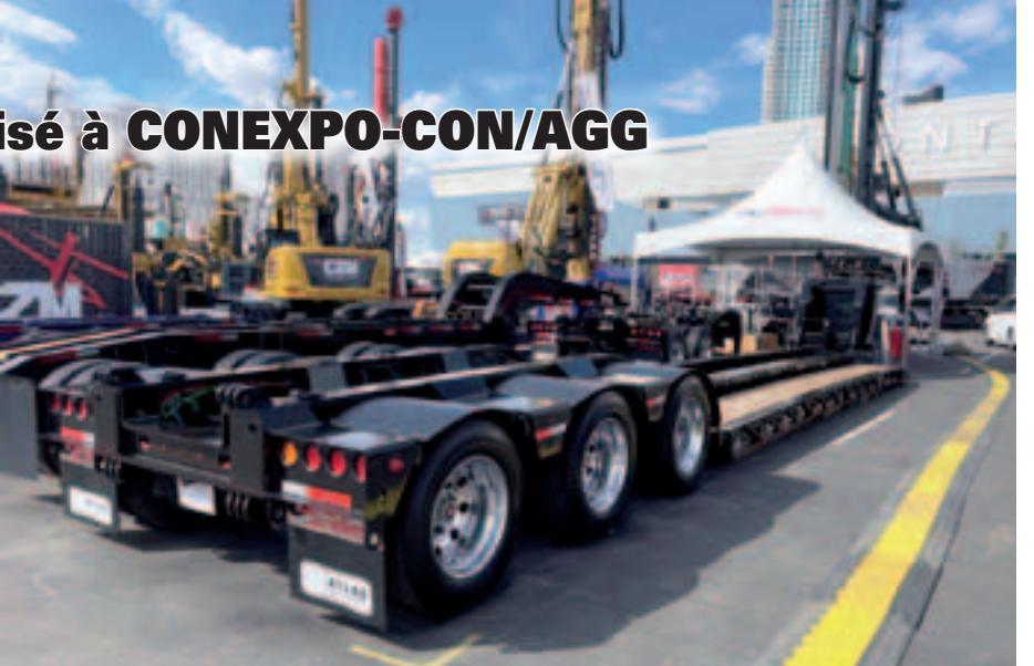
égaliser les pressions des essieux. En outre, elle dispose d'un pivot de roulement et d'un verrouillage de pivot pour les manœuvres en marche arrière. Les utilisateurs peuvent également verrouiller hydrauliquement les charges sur les essieux, quel que soit le terrain.
