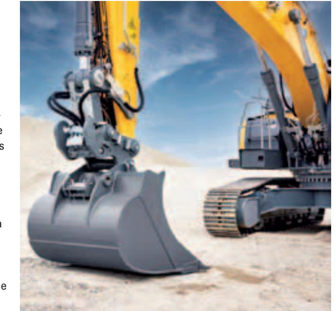
Les systèmes d'attache rapide de Liebherr, qui ont fait leurs preuves depuis plusieurs décennies et qui sont en permanence perfectionnés, garantissent une efficacité, une sécurité et une flexibilité maximales. Ils rendent le changement d'outil porté hydraulique ou mécanique rapide et facile. Le système, connu jusqu'à maintenant sous le nom de LIKUFIX sera désormais présenté sous la nouvelle marque Solidlink sur le marché international.
